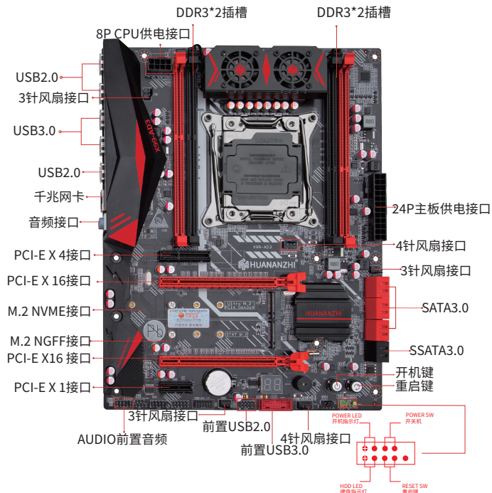
图1-1 X99-AD3 V3.0 主板图解
